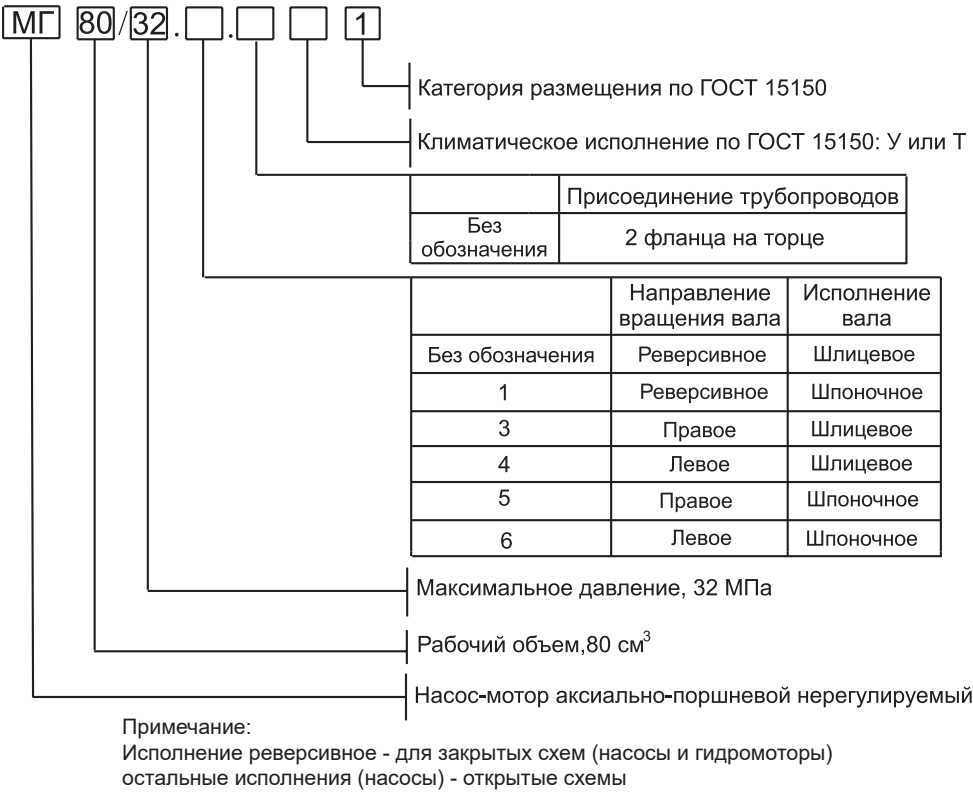
Структурная схема обозначения насос-моторов МГ 80/32
