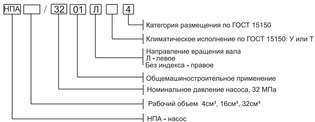
Структурная схема обозначения насоса НПА.../32-01
